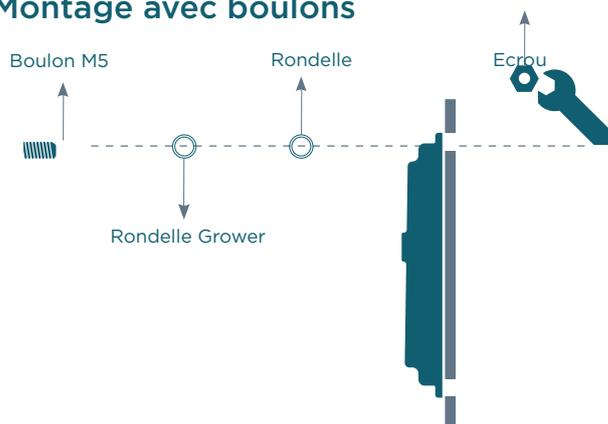
1. Il est recommandé d'utiliser des boulons M5 et d'utiliser de la colle de fixation sur les boulons. Nous recommandons la colle *Loctite Thread Locker Blue 242*.
