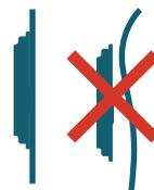
Assurez-vous que les surfaces de montage soient plates et propres, cela assurera un lien fort et durable avec l'équipement et sécurisera la fonction de détection de sabotage.
